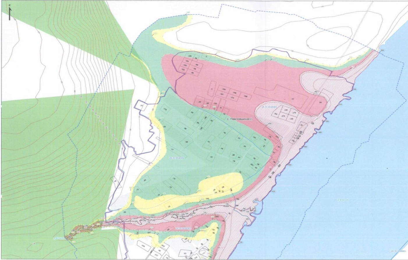
Карта расположения границ зон затопления, подтопления территорий, прилегающих к рекам Бухало, Енисей в границах с. Павловщина Сухобузимского района Красноярского края
